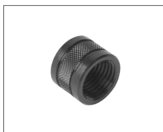
Gewindebuchse für Laufgewinde 1/2 Zoll – 20 UNF. Aussendurchmesser: Ø 16 mm. Thread protector for barrel thread 1/2" – 20 UNF. Outer diameter: Ø 0.63 inch.
